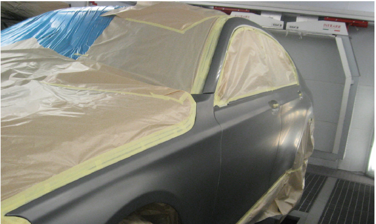
Bild 1b (Dach seitlich wird mitlackiert)
