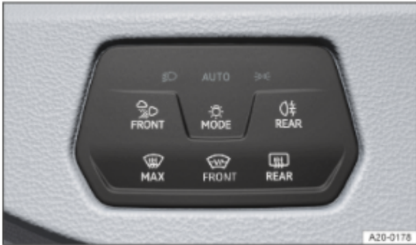
Abb. 1 Neben dem Lenkrad: Bedienfeld zum Einschalten der Außenbeleuchtung.
