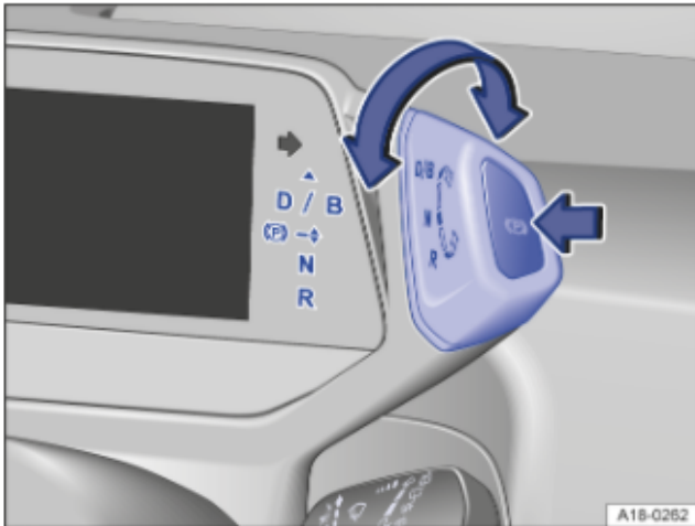
Abb. 1 Fahrstufenschalter mit der Taste für die elektronische Parkbremse (Pfeil).
